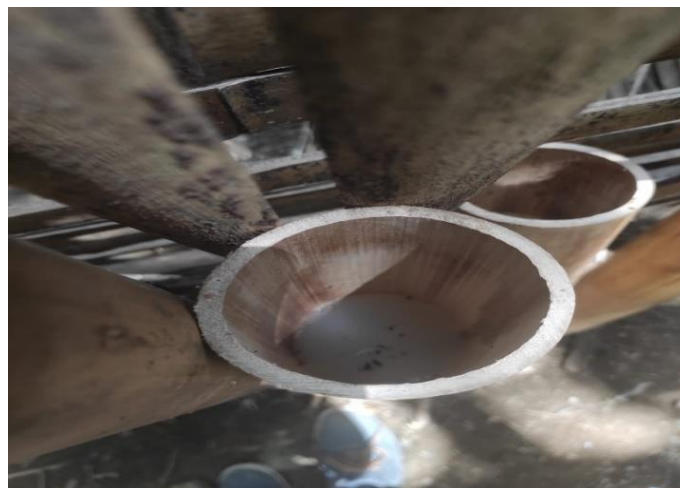
Gambar 4. Proses pengawetan menggunakan ballo ' (Sumber: Dokumentasi penulis, 2022)
